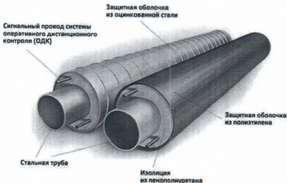
Рисунок 3 – Схема устройства труб ППУ с полиэтиленовой и оцинкованной оболочкой
